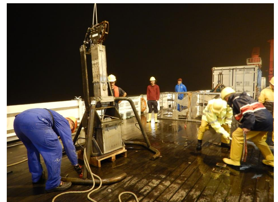
„Box corer” przy pracy, wyprawa KuramBio II, 08.2016, fot. A. Jażdżewska
