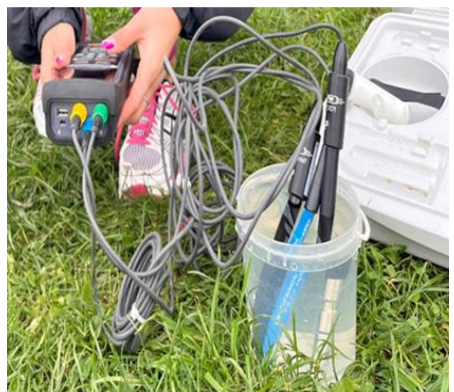
Pomiary sondą wieloparametryczną, rok 2023, fot. N. Soporowska
